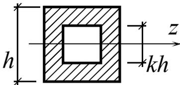
Задано сечение в виде полого квадрата. При каком значении коэффициента  $k$  момент инерции сечения относительно центральной оси  $z$  равен квадрату площади поперечного сечения ( $J = A^2$ ).
