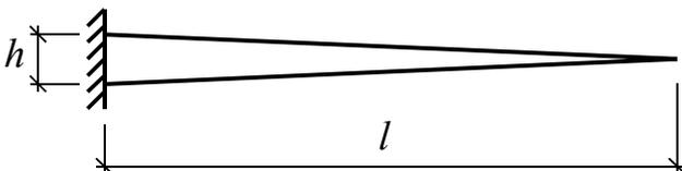
Консольная балка переменного сечения (высота сечения линейно зависит от координаты) нагружена собственным весом. Найти наибольшее нормальное напряжение.  $\gamma$ ,  $l$ ,  $h$ , - заданы
