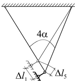
Узел, в котором приложена сила, может перемещаться только вдоль оси стержня №1. Из деформированного вида фермы получаем
